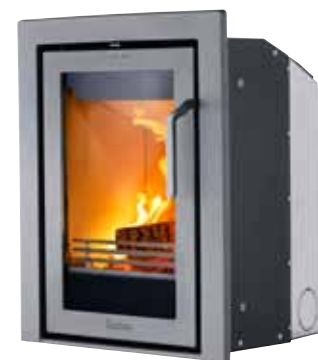
Cadre 3 côtés Pour une installation dans l'ouverture du foyer. Cadre en fonte 3 côtés (590 x 490 mm) avec poignée amovible. Clapet sur le bord supérieur. Grille et cendrier. Noir ou gris.
